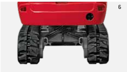
BREEDTE INGESCHOVEN ONDERWAGEN 980 MM
